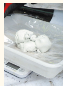
①主剤・硬化剤を使用量に応じて計量し小分けする。(左:右=主剤:硬化剤)
