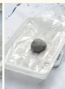
①主剤・硬化剤を使用量に応じて計量し小分けする。(左:右=主剤:硬化剤)
