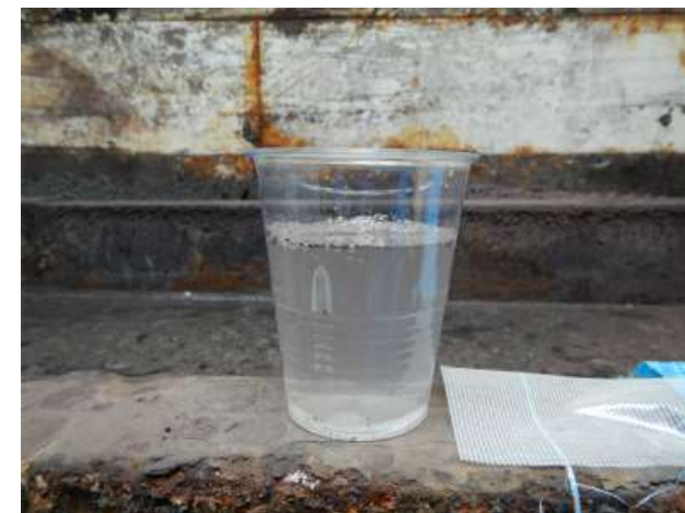
※上澄みは非常にクリアな状態を維持している。
